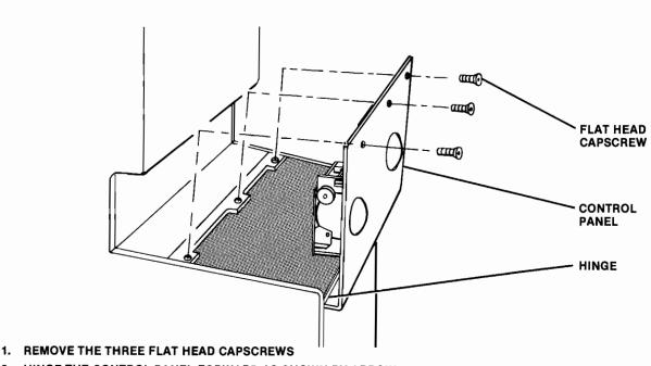
2. HINGE THE CONTROL PANEL FORWARD AS SHOWN BY ARROW
